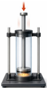
وصف الشكل 1-5-5: مكبس نار؛ يؤدي دفع المكبس سريعاً إلى أسفل إلى ضغط الهواء المحبوس أديباتياً، فترتفع درجة حرارته إلى حد يشعل القطن بوميض
