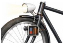
شكل (8.4.4) دينامو دراجة: مغناطيس دوار يُغيّر الفيض خلال ملف، فيستحثّ قوة دافعة تُضيء المصباح.
