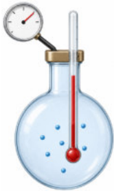
شكل (2.2.1): دورق صلب محكم ثابت الحجم، مزود بمقياس ضغط وترمومتر.
