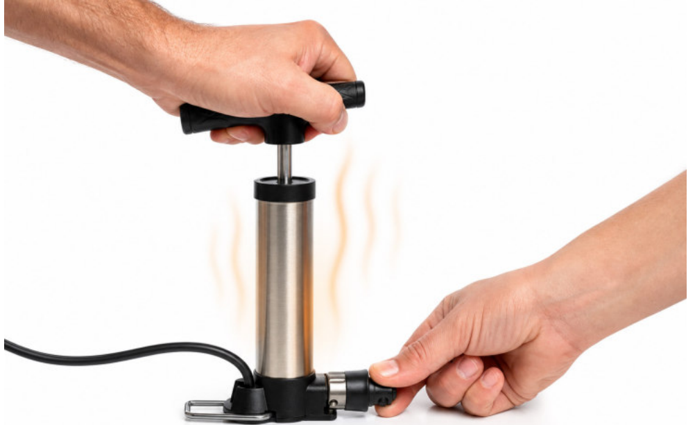
وصف الشكل 1-5-1: مضخة دراجة محكمة؛ يغلق إصبع الفوهة بينما يُدفع المكبس إلى الداخل، فينضغط الهواء المحبوس ويسخن.
