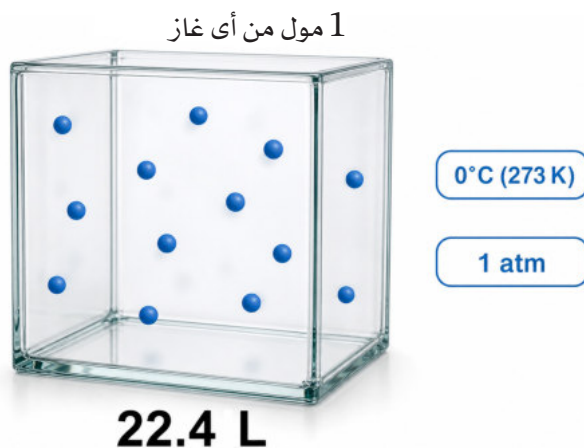
شكل (3.2.1): يشغل مول واحد من أي غاز مثالي حجم 22.4 \text{ L} في الحالة القياسية عند 0^\circ\text{C} وضغط 1 \text{ atm} .
