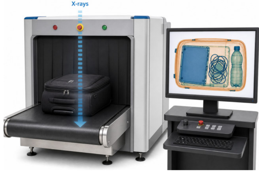
شكل 5-2-1: ماسح مطاير يصنع أشعة سينية بدفع إلكترونات معجلة إلى هدف معدني؛ وتنفذ الأشعة خلال الحقيبة لتصوير محتوياتها.
