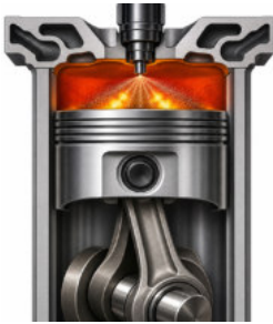
الشكل 1-5-4: عند نهاية شوط الانضغاط في محرك الديزل يُحصر الهواء في حيز صغير شديد السخونة، فتشتعل حزمة الوقود الدقيقة المرشوشة من الحاقن من دون شمعة إشعال.
