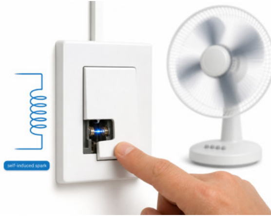
شكل (1.5.4) إطفاء دائرة تحمل ملفاً: مع قطع التيار، يستحث الملف فرق جهد كبيرة تُشعر عبر التلامسات المنفتحة.
