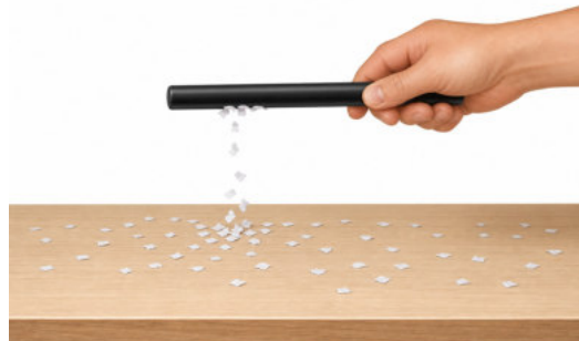
وصف الشكل 3-1-2: يرفع قضيب مشحون قصاصات الورق الواقعة تحته مباشرة، بينما تبقى القصاصات الأبعد ساكنة، موضحاً الانخفاض الحاد في قوة التجاذب الكهروستاتيكية مع المسافة.
