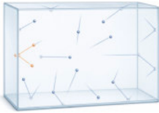
شكل (5.3.1): تتحرك جزيئات الهواء كالرصاصة بسرعة تقارب 500 \text{ m/s} وترتد مرئاً عن الجدار؛ وكل اصطدام يسهم في الضغط الكلي.
