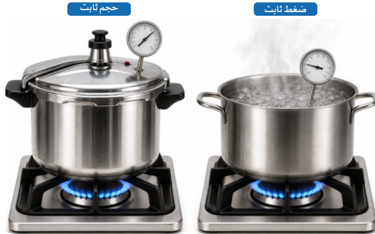
شكل (1.6.1): مقدار كمية الحرارة تُزوّد قدر ضغط مغلقاً، حيث الحجم ثابت، وإناءً مفتوحاً، حيث الضغط ثابت. يسخن الغاز الذي لا يستطيع التمدد بدرجة أكبر
