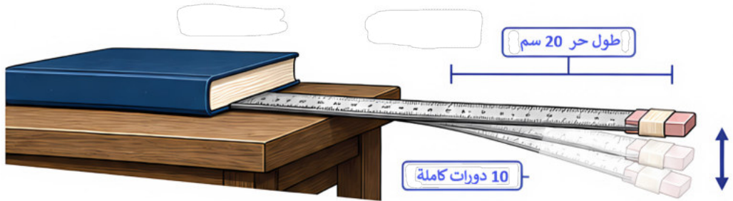
الشكل (3.1.2): قياس زمن عشر اهتزازات كاملة لمسطرة ذات طول حر قدره 20 cm
